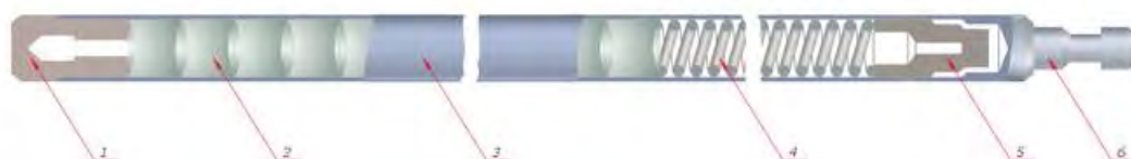
Устройство ТВЭЛа реактора РБМК: 1 – заглушка; 2 – таблетки диоксида урана; 3 – оболочка из циркония; 4 – пружина; 5 – втулка; 6 – наконечник.
